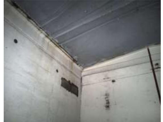
Toits intérieurs de wagons réfrigérés remis à neuf avec apprêt anti-rouille, Rust-Anode Primer
