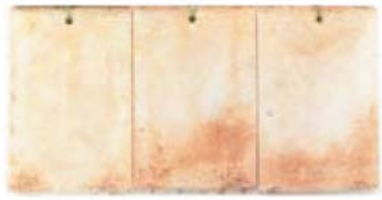
Galvanizado en caliente 10000 horas
